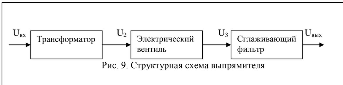
Рис. 9. Структурная схема выпрямителя
