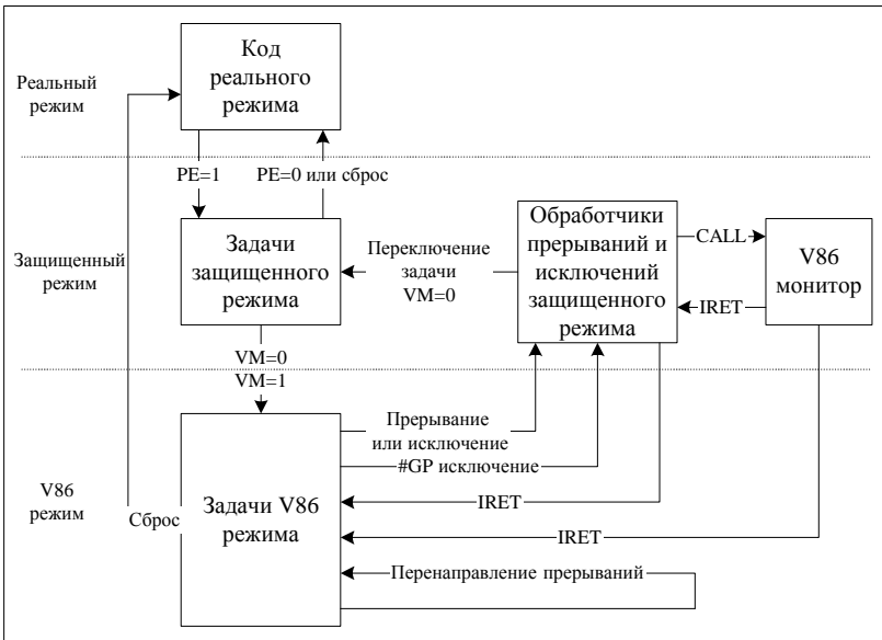
Рис. 2.13—Вход и выход в/из Virtual-8086 режим(а)
